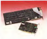
La struttura da inserire nel computer per gestire i drive ottici sono completamente diverse: Optotech ha sviluppato un controller adatto per il PC che integra l'interfaccia di collegamento serie e propria montata in 16-pin, anche per il controllo di compressione degli archivi. Questo però contrasta ad un maggiore ingombro per occupare un solo slot a 8 bit. Maxtor usa invece solo una cartuccia SCSI a mezza lunghezza, in questi casi prodotti della Future Domain.
